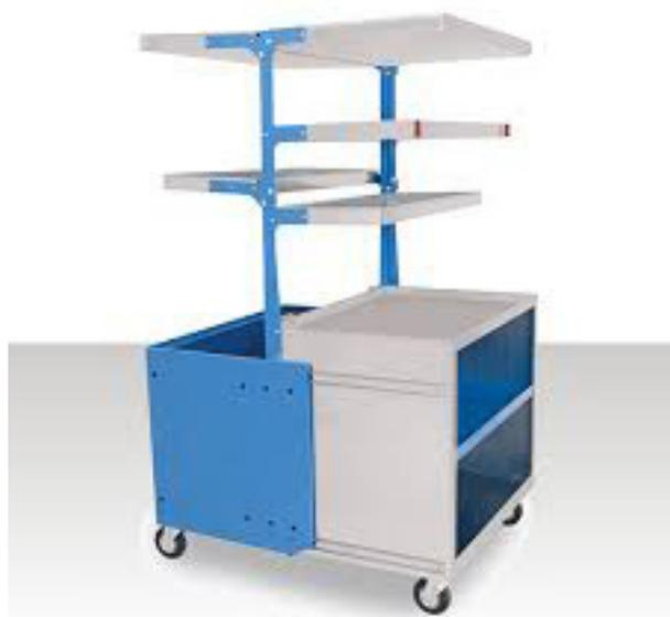
CARSPACE 2 é um carrinho extensível projetado para colocar partes do carro desmontadas. Na base tem quatro lugares onde se poderá colocar todo o tipo de peças de forma segura e prática, para não danificar as peças durante o trabalho de reparação.
